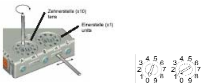
Rys. 3 Sposoby ustawiania adresu modułów serii 900.
